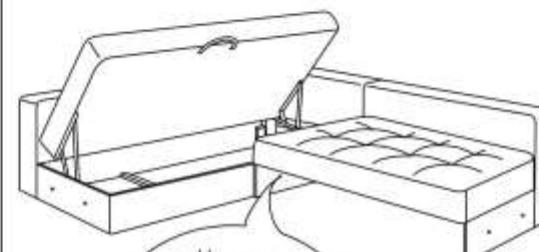
2. Установить опоры (поз.5) на место и закрепить к диванной и боковой частям с помощью самореза (поз.6), как показано на рисунке.
