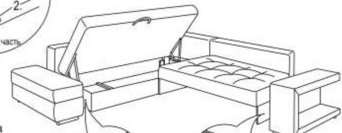
4. Установить малую боковину на место. Закрепить к боковой части мягкого угла болтом 8x50 (поз.1) и шайбой M8 (поз.4), как показано на рисунке.
