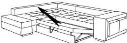
3. Взять за петлю нижнюю платформу, поднять вверх и потянуть на себя, в верхнем положении нажать на платформу вниз и толкнуть вперед.
