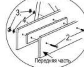
3. Совместить отверстия диванной и боковой частей мягкого угла и закрепить между собой болтом 8x70 (поз.2), шайбой (поз.4) и гайкой (поз.3), предварительно установив на место дистанционную планку, как показано на рисунке.
