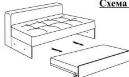
1. Выдвинуть платформу диванной части, приподнять и выкатить наружу, как показано на рисунке. Установка выкатной платформы производится в обратной последовательности.
